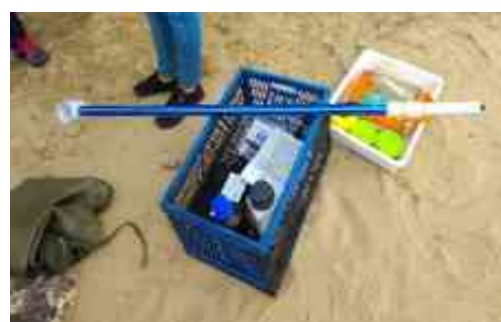
Figura 24: Molinete para obtenção da velocidade da água.
